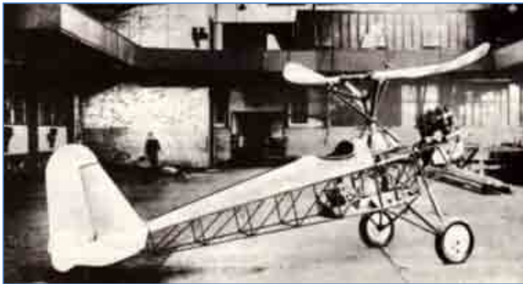
Rieselers Traghubschrauber mit Bugmotor und zwei kleinen Rotorblättern 1927 in einer Halle am Flugfeld. Die ersten Probeflüge fanden in Hamburg statt. 25
