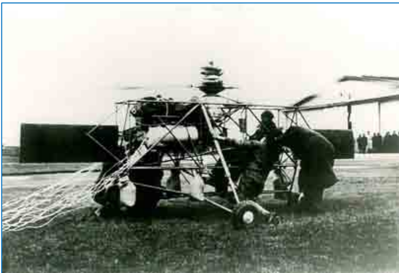
Gesamtansicht des Hubschraubers beim Standlauf und Johannes Mohns Vorbereitungen für einen Probeflug.
